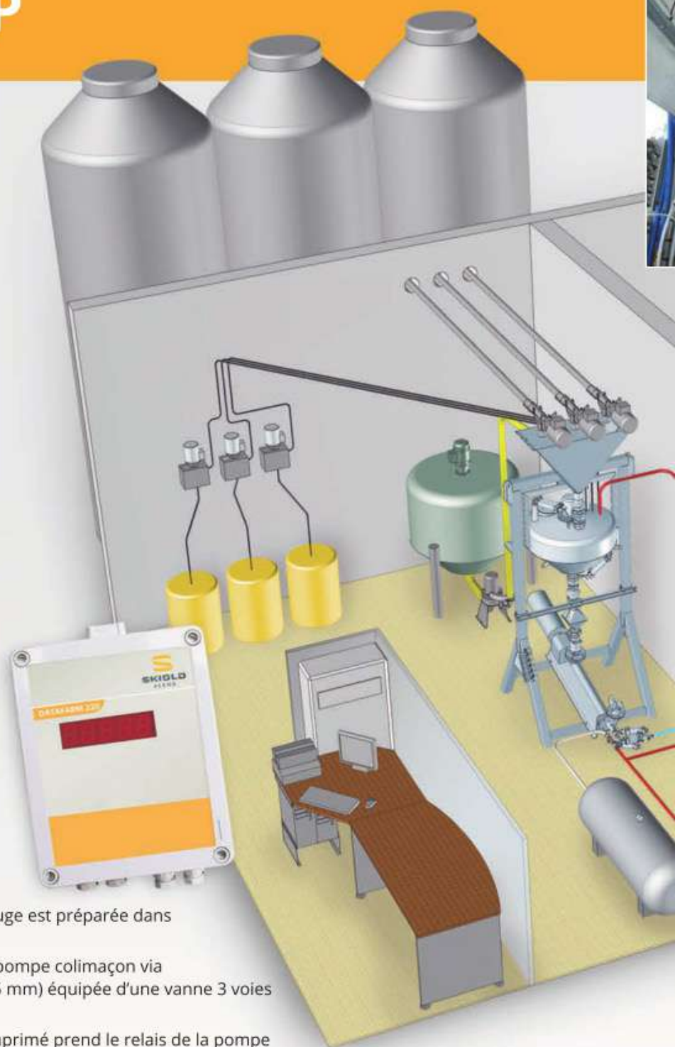
Pesage par 1 capteur inox à jauges de contraintes relié à un conditionneur Type Datafarm 220 | Résolution 30 grammes
