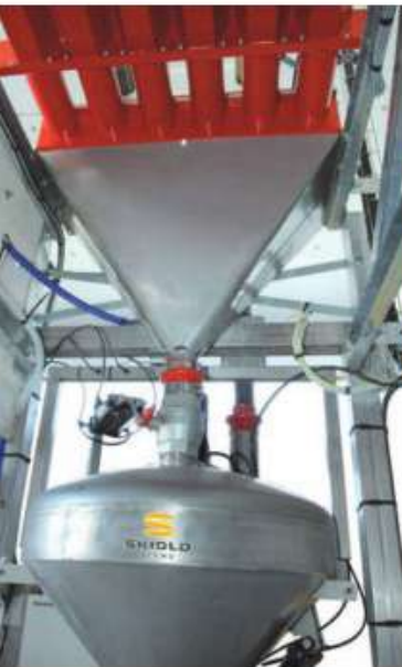
Cône de chargement des produits secs avec vanne d'isolement à manchon pneumatique
