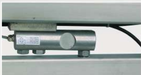
Pesage par 1 capteur inox à jauges de contraintes relié à un conditionneur Type Datafarm 220 | Résolution 30 grammes
