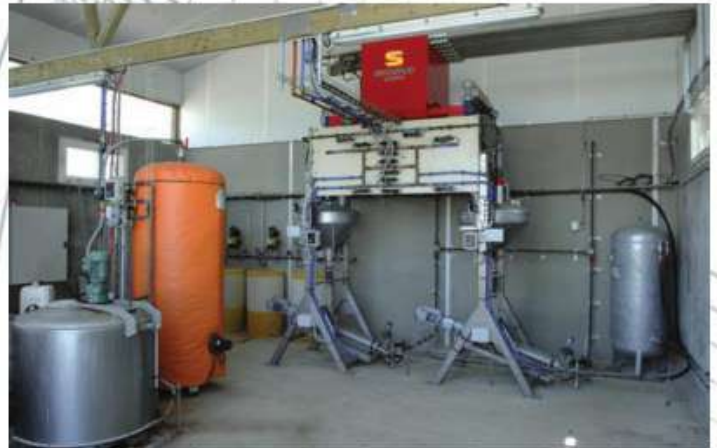
Photo d'une installation de deux aérosoup alimentant 9000 places de post sevrage de 6 à 35 kg.
